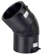
Elbow 45° SDR 11 PE 100 Gas : 10 Bar / Water : 16 Bar
